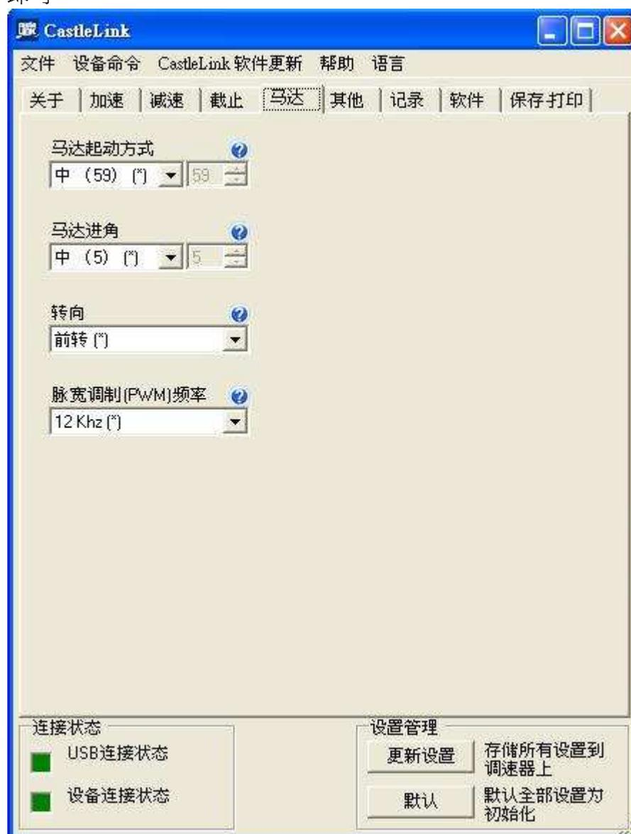
**馬達啓動方式:**此數值的大小為馬達從靜止狀態到開始轉動時的力量，若是啓動時馬達出現”科科科”現象之後才開始轉起來,表示馬達啓動力量過小，可以調高此數值獲得解決，調整前請先確認無其他干涉情形造成此一現象後再來增加啓動的力量。此參數調整的範圍為 0~100，數字越高代表啓動力量越大，出廠預設值為 59。
